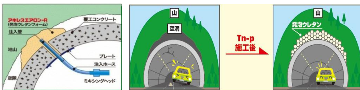
図-3 Tn-p 工法のイメージ
