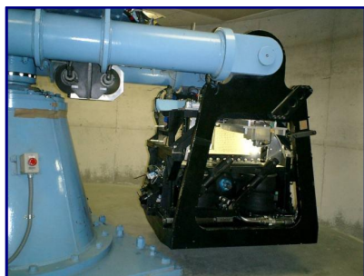
遠心振動台実験装置
