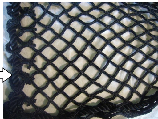
写真-4 N ネット外周ロープ
