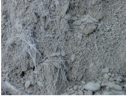
写真-3 短繊維混合状況
