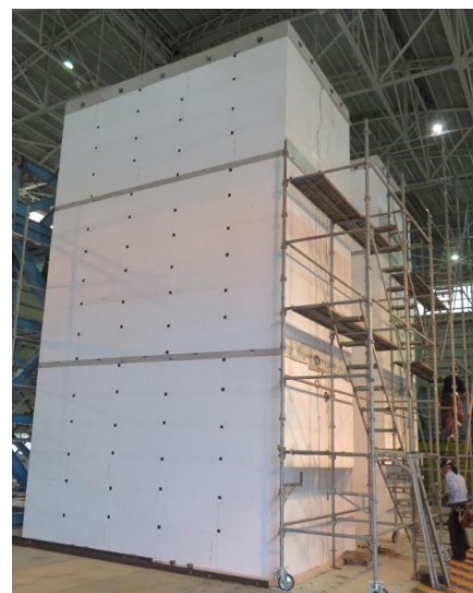
写真-1 実験に用いた EPS 盛土 (H8.5m×W5.0m)
