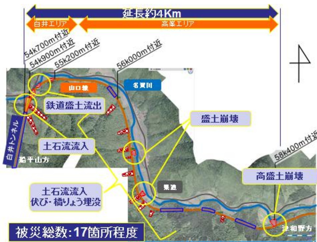
図-13 船平山ー津和野間の被災状況
