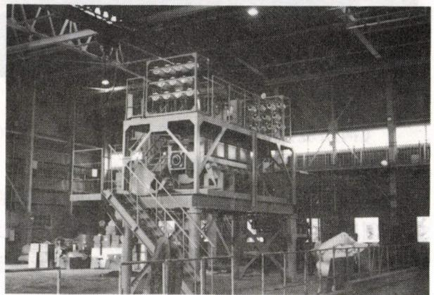
写真-6 ハイグレードソイル製造装置
