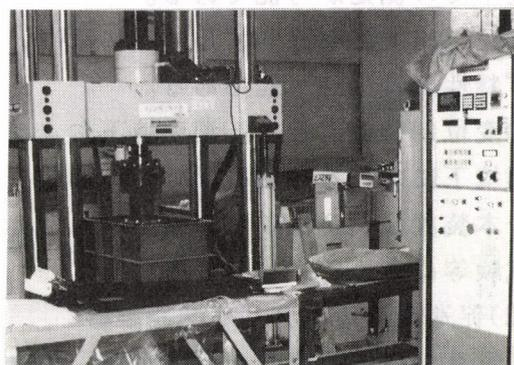
写真8 凍結融解繰返し載荷試験装置
