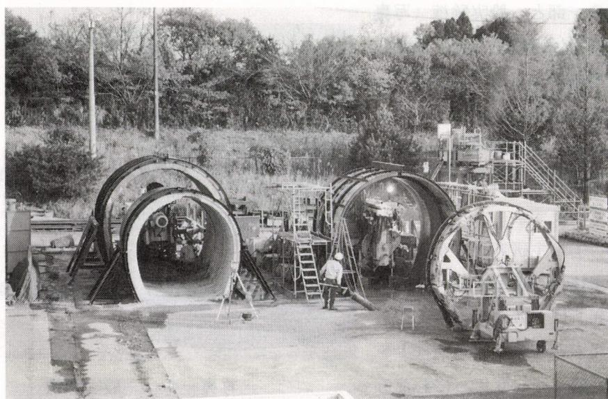
写真-2 模擬トンネルを用いての実証実験
