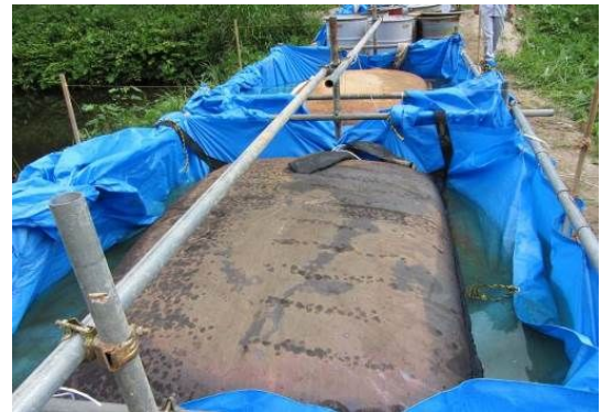
放射性物質汚染底泥の封じ込め実験状況
