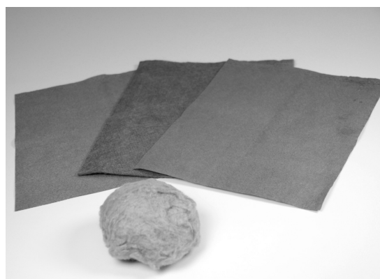
写真－６ セシウム吸着繊維材「Cs CATCHER」
