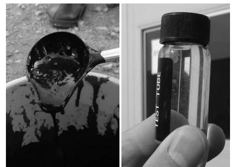
写真-6 (a) 脱水前の底質 (b) 脱水後の排水
