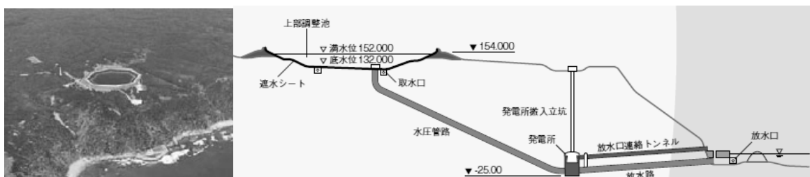
図-3 沖縄やんばる海水揚水発電所の断面図
