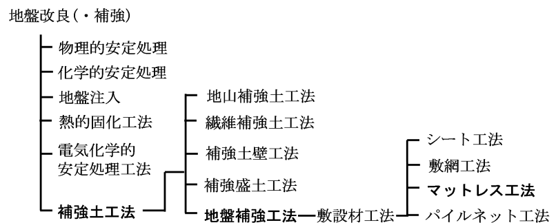
図-2 地盤改良・補強に関する工法の大分類と地盤補強工法の位置づけ (筆者が、地盤工学会用語辞典, 2006 の付録(p514)にまとめられている地盤改良の樹形図をもとに、当該辞典の本文中の工法分類表(p411)の大分類の内容をほぼ含んだもの。付録では、「地山補強土工法」のところが「ジオシンセティックス」となっていた。何がしかの意図があるようにも思えたが、ここでは工法分類表を優先した。)
